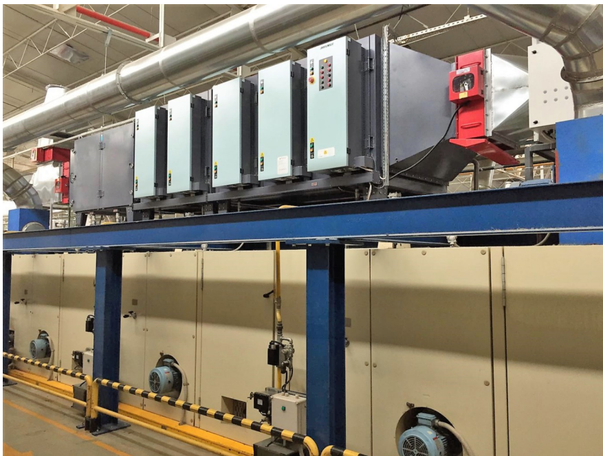
Линия промышленного ESP на сервисной платформе цеха
